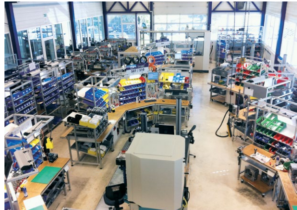
Islas de montaje con sistema Karban
