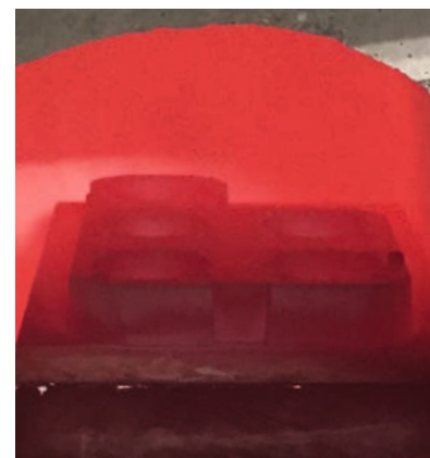
portapiezas AM-LOCK – comprobado en el horno a 750°C
