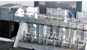
Piezas desconocidas en el dispositivo tensor múltiple - puente: pL LEHMANN
