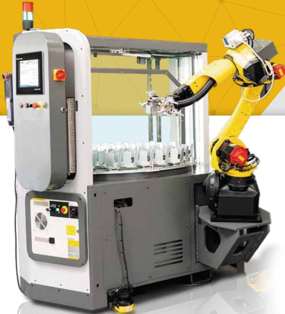
Con **CUBEBOX Blues**, se pueden almacenar piezas redondas, unas encima de otras, para obtener más capacidad de trabajo e integrar barras redondas largas en la automatización.
